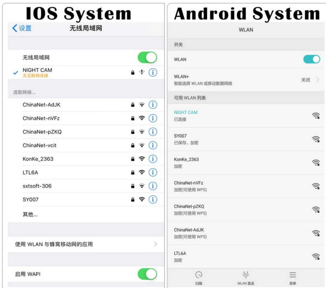
3. Wählen Sie den WIFI-Namen der Kamera, geben Sie das Kennwort nach dem Herstellen der Verbindung ein. Das Standardkennwort lautet 00000000 (8 Nullen).
