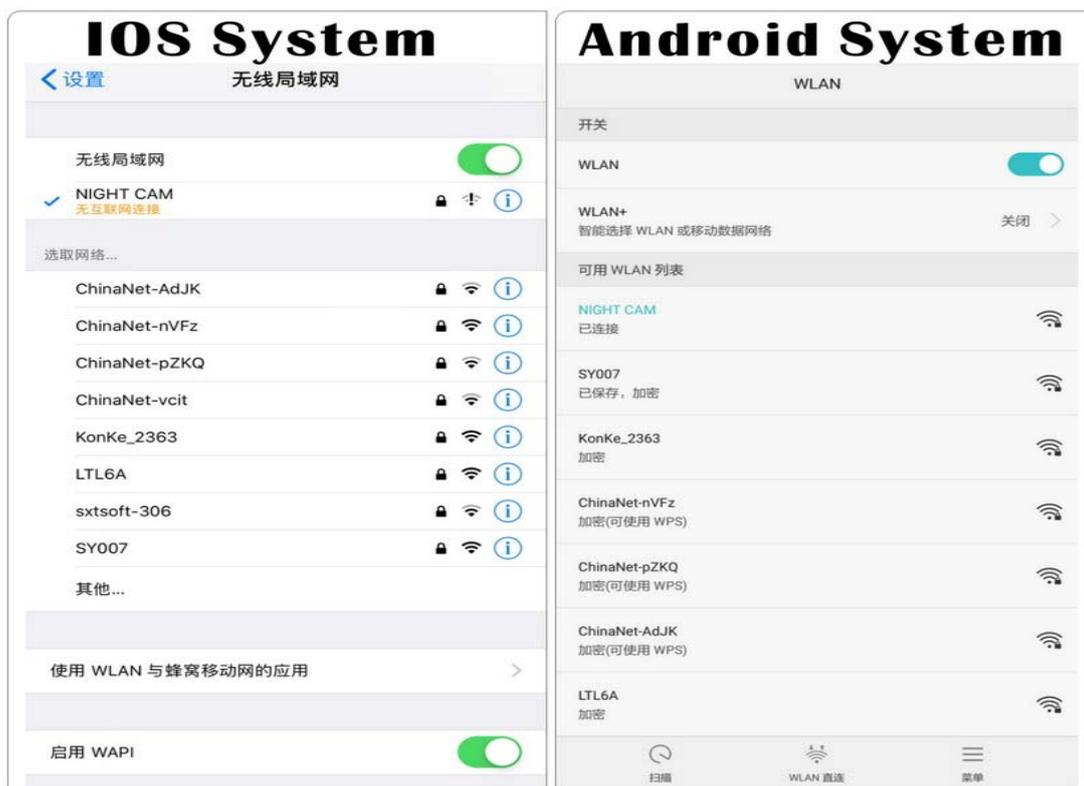
3. Wählen Sie den WIFI-Namen der Kamera, geben Sie das Kennwort nach dem Herstellen der Verbindung ein. Das Standardkennwort lautet 00000000 (8 Nullen).
